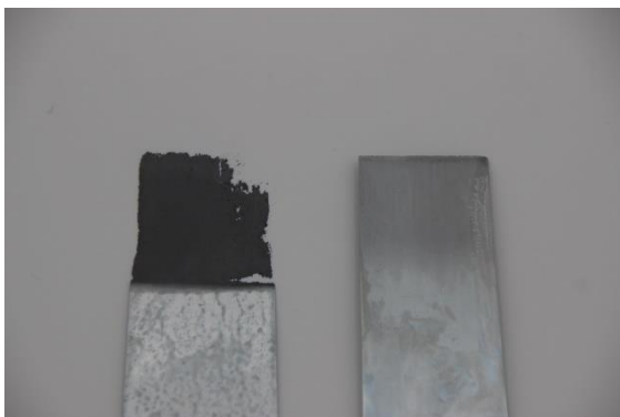
Zink 10 Minuten: links ohne Schutz, rechts mit Korrosionsschutz (leichte Verfärbungen)
